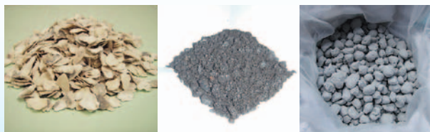
左から、カキ殻、鉄鋼スラグ、石炭灰造粒物
